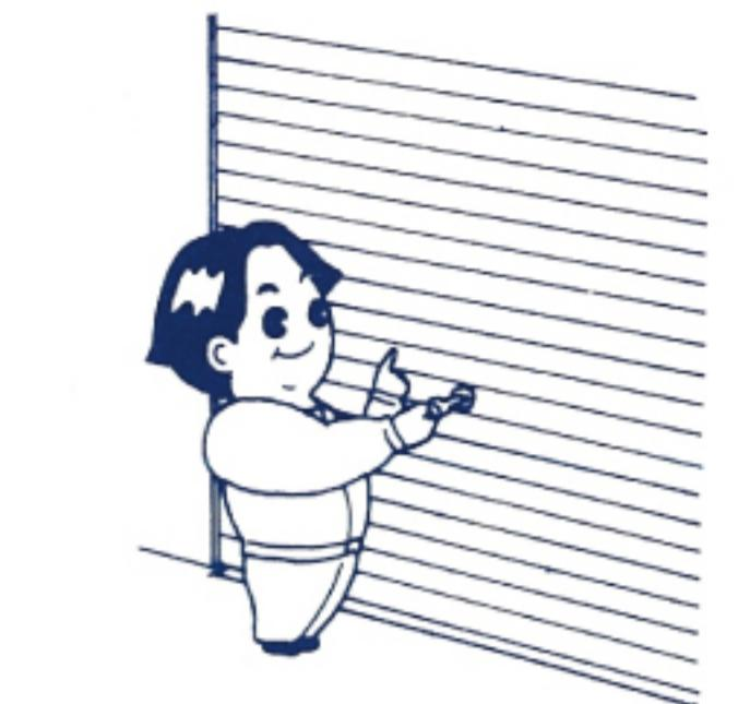
スラットの中間位置に取付けられた手掛けに手をかけて上に押し上げてシャッターを開けます。開口部の高いシャッターは途中よりフック棒を使ってゆっくりとマグサまで上げてください。
